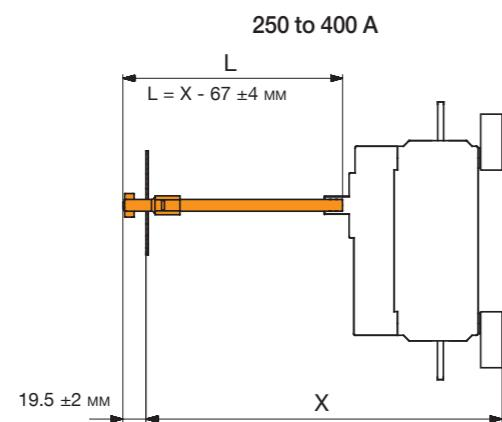
Mounting of auxiliary contacts / Montaža pomožnih kontaktov / Montaža pomocných kontakata /
